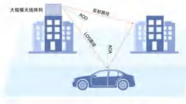
图 8 基于超大规模天线阵列的高精度定位
