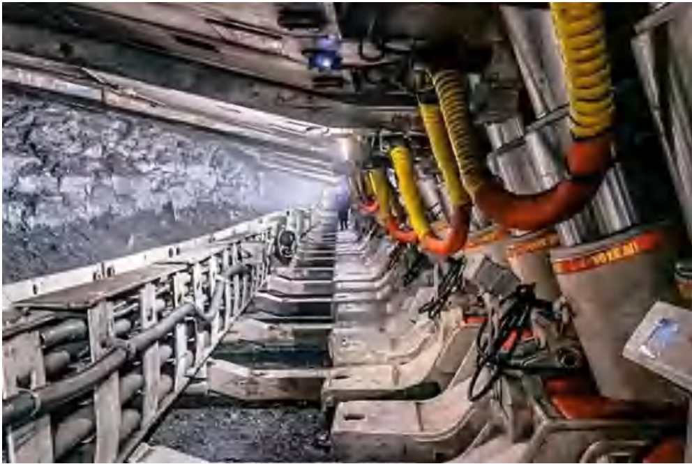
图 3 国产首套 450m 智能化综采工作面
